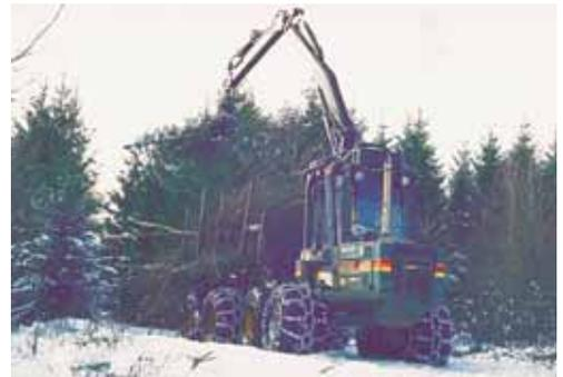
Abb. 8. Schweres Gerät für den Naturschutz im Forstamt Hofbieber: Während der Frostperiode stapelt ein „Forwarder“ Schnittgut in einer Biotopschneise im Revier Hohlstein (25. Februar 1998).
